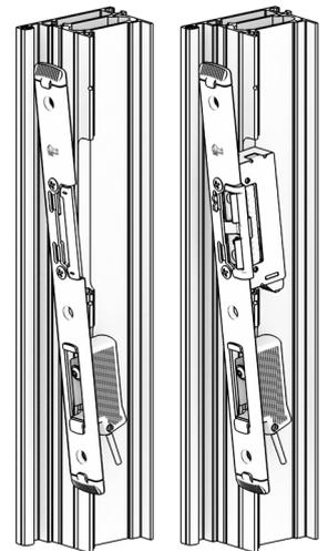
7. Schraube zum Einstellen des Schaltpunktes je nach Bedarf teilweise herausdrehen oder ganz entfernen (Inbus SW 2,5).
