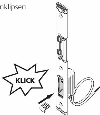
5. Fertig montiertes Schließteil
