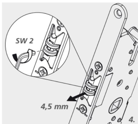
**Achtung!** Nur mit Stoßgriff verwenden. Rollfalle ist über den Wechsel einziehbar.
